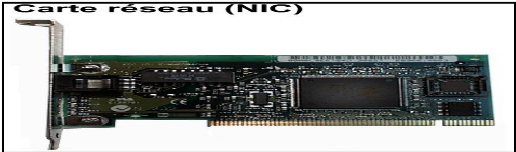
Le rôle de la carte réseau est de préparer, d'envoyer et de contrôler les données du réseau.
