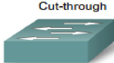
Un commutateur cut-through achemine la trame avant qu'elle ne soit entièrement reçue. Au minimum, l'adresse de destination de la trame doit être lue avant que celle-ci ne soit retransmise.
